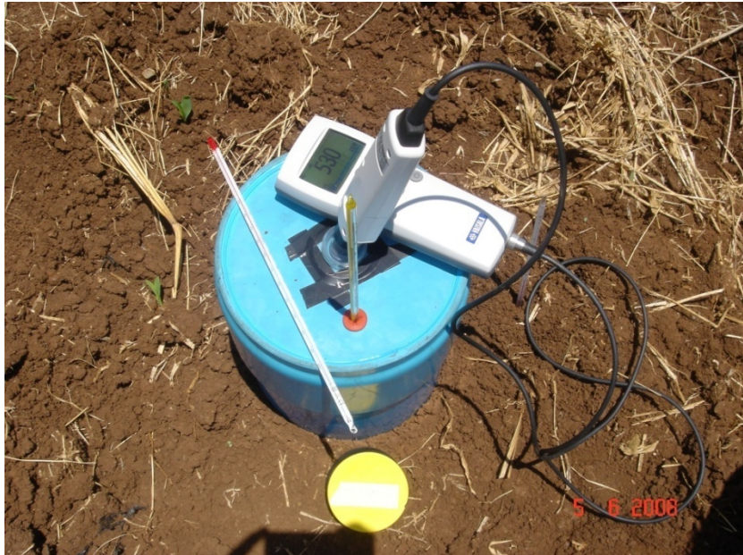
ภาพที่ 3 การวัดการปลดปล่อยก๊าซคาร์บอนไดออกไซด์จากดินโดยเครื่องวัดก๊าซคาร์บอนไดออกไซด์แบบพกพาจากกระบอกเก็บก๊าซระบบปิดแบบยึดติดในแปลงทดลอง
